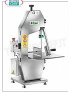
**BANDSÄGE (mm 1550), auf Schrank in LACKIERTER METALLLEGIERUNG, dreiphasig, V.400 / 3**
