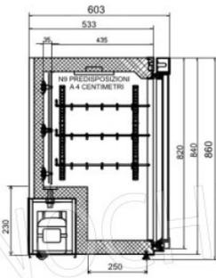
Massima capacità n4 griglie, per un totale di 24 bottiglie diametro 80 mm
