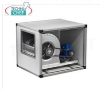
**Zentrifugalsauger mit 2 Geschwindigkeiten, maximale Durchflussrate 2000/1317 m<sup>3</sup>/h, V.380/3 SAUGKASTEN MIT GETRIEBE-ZENTRIFUGALVENTILATOR mit RIEMEN und RIEMENSCHLEIBEN, EDELSTAHL-Platten, 2 GESCHWINDIGKEITEN, max. Durchflussrate 2.000/1317 m<sup>3</sup>/Kubik/Stunde, Umdrehungen 1440/948, db 65/52, V.380/3, Kw.0, 55/0,18, Gewicht 40 kg, Abm. mm. 800 x 600 x 600 h**
