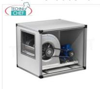
**Zentrifugalsauger mit 2 Geschwindigkeiten, maximale Durchflussrate 2500/1673 m<sup>3</sup>/h, V.380/3 ASPIRATOR MIT KASTEN, KREUZLÜFTER MIT ÜBERTRAGUNG, mit RIEMEN und RIEMENSCHLEIBEN, INOX-Platten, 2 GESCHWINDIGKEITEN, max. Durchfluss 2500/1673 m<sup>3</sup>/Kubik/Stunde, Umdrehungen 1450/970, db 67/52, V.380/3, Kw.0, 81 /0,28, Gewicht 41 Kg, Abm.mm.800x600x600h**
