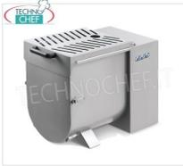
Fleischmischer aus Edelstahl, Schüsselkapazität 50 kg, abnehmbares Edelstahlmesser, V.400/3, 1.472 kW, Gewicht 49 kg, Maße 750 x 465 x 595 mm
