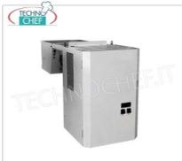
Wandmontierte Monoblock-Kühleinheit TN, tropenfest, für Normaltemperatur -2°+8° belüftet, mit ökologischem Gas R404a, V 230/1, Kw 2,0 - Gewicht Kg 87, Außenabmessungen mm 1045x735x1040h
