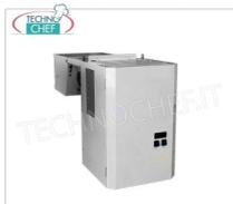
**Wandmontierte Monoblock-Kühleinheit TN, tropfenfest, für Normaltemperatur -2°+8° belüftet, mit ökologischem Gas R404a, V 400/3+N, Kw 1,8 - Gewicht Kg 85, Außenabmessungen mm 1035x735x1040h**
