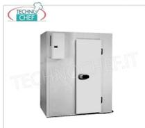
**Vorgefertigter Kühlraum, geeignet für normale Temperaturen (-2°+8°), aus modularen Sandwichpaneelen, 70 mm dick, mit Drehtür und Boden, 11,52 Kubikmeter, Außenmaße, mm. 2540x2540x2140h**
