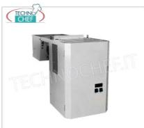
Wandmontierte Monoblock-Kühleinheit TN, tropenfest, für Normaltemperatur -2°+8° belüftet, mit ökologischem Gas R404a, V 400/3+N, Kw 1,8, Gewicht Kg 85, Außenabmessungen mm 1035x735x1040h
