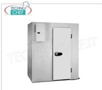
**Vorgefertigter Kühlraum für normale Temperaturen (-2°+8°), aus modularen Sandwichpaneelen, 70 mm dick, mit Drehtür und Boden, 9,6 Kubikmeter, Außenmaße 2140 x 2540 x 2140 h mm**
