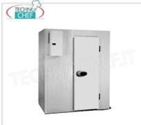
Vorgefertigter Kühlraum, geeignet für normale Temperaturen (-2°+8°), aus modularen Sandwichpaneelen, 70 mm dick, mit Drehtür und Boden, 8,96 Kubikmeter, Außenmaße, mm. 1740x2940x2140h
