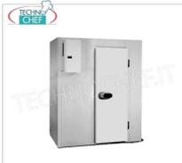
**Vorgefertigter Gefrierraum, geeignet für niedrige Temperaturen (-14°-22°), aus modularen Sandwichplatten, 100 mm dick, mit Drehtür und Boden, 4,96 Kubikmeter, Außenmaße, mm 1640x1840x2300h**
