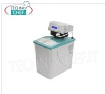
**Automatischer Wasserenthärter-Reiniger mit 5-Liter-Gehäuse, mit 3,5 Litern Harz, Serie AL, chronometrisches ALIA-Ventil, max. Durchflussrate 1400 l/h, 3/4''G-Wasseranschluss, LCD-Display und Salzmangelwarnung, V.230/1, Watt.4, Gewicht 11 kg, Maße mm.230x360x460h**
