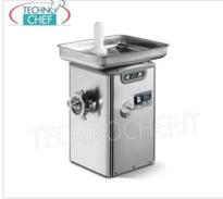
Gekühlter Fleischwolf mit Öffnung 22, mit thermoelektrischem Kühlsystem an Hals und Öffnung, Leistung 350 kg/h, V.400/3+N, 1.472 kW, Gewicht 34 kg, Maße mm 310 x 350 x 540
