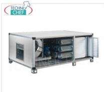
**DESODORISIERUNGS-STEUREINHEIT mit 9 ZYLINDERN** aus pflanzlicher Aktivkohle, elektrostatichen, Taschen- und synthetischen Vorfiltern, max. Durchflussrate 3000 m<sup>3</sup>/cu/h, 1750 U/min, V.400/3, Kw.1,5, Gewicht 160 kg, Maße 2300 x 670 x 670 mm
