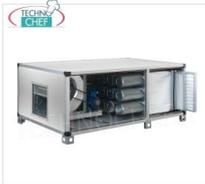
**DESODORISIERUNGS-STEUREINHEIT mit 28 ZYLINDERN** aus pflanzlicher Aktivkohle, elektrostatischen, Taschen- und synthetischen Vorfiltern, max. Durchflussrate 9000 m<sup>3</sup>/cu/h, 950 U/min, V.400/3, Kw.4,00, Gewicht 390 kg, Abm. mm.2900x1280x980h
