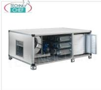
**DESODORISIERUNGS-STEUREINHEIT mit 23 ZYLINDERN** aus pflanzlicher Aktivkohle, elektrostatischen, Taschen- und synthetischen Vorfiltern, max. Durchflussrate 7500 m<sup>3</sup>/cu/h, 1150 U/min, V.400/3, Kw.3,00, Gewicht 350 kg, Maße 2700 x 1590 x 800 mm
