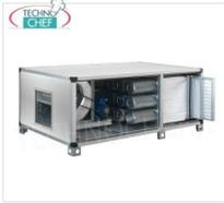
**DESODORISIERUNGS-STEUREINHEIT mit 14 ZYLINDERN** pflanzlicher Aktivkohle, elektrostatischen, Taschen- und synthetischen Vorfiltern, max. Durchflussrate 4500 m<sup>3</sup>/cu/h, 1280 U/min, V.400/3, Kw.2,2, Gewicht 210 kg, Abm. mm.2300x980x750h
