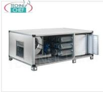
**DESODORISIERUNGS-STEUREINHEIT mit 18 ZYLINDERN** aus pflanzlicher Aktivkohle, elektrostatischen, Taschen- und synthetischen Vorfiltern, max. Durchflussrate 6000 m<sup>3</sup>/cu/h, 1250 U/min, V.400/3, Kw.3,00, Gewicht 300 kg, Abm. mm.2400x1280x800h
