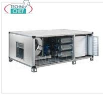
**STEUEREINHEIT für Absaugung, Filterung und Geruchsneutralisierung mit 18 Zylindern aus pflanzlicher Aktivkohle, Taschenvorfilter und 2 synthetischen Filtern, max. Durchflussrate 6000 m<sup>3</sup>/cu/h, 1200 U/min, V.400/3, Kw.2,2, Gewicht 290 kg, Maße mm 2100 x 1280 x 800**
