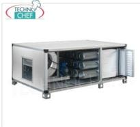
**STEUEREINHEIT für Absaugung, Filterung und Geruchsneutralisierung mit 23 Zylindern aus pflanzlicher Aktivkohle, Taschenvorfilter und 2 synthetischen Filtern, max. Durchflussrate 7500 m<sup>3</sup>/cu/h, 1120 U/min, V.400/3, Kw.3,00, Gewicht 330 kg, Maße 2400 x 1590 x 800 mm**
