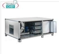
**STEUEREINHEIT für Absaugung, Filterung und Geruchsneutralisierung mit 28 Zylindern aus pflanzlicher Aktivkohle, Taschenvorfilter und 2 synthetischen Filtern, max. Durchflussrate 9000 m<sup>3</sup>/cu/h, 900 U/min, V.400/3, Kw.3,00, Gewicht 360 kg, Maße mm 2600 x 1280 x 980**
