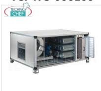
**Saug-, Filter- und Desodorierungseinheit mit 9 Zylindern aus pflanzlicher Aktivkohle, elektrostatischen und synthetischen Vorfiltern, max. Durchflussrate 3000 m<sup>3</sup>/cu/h, 1600 U/min, V.400/3, Kw.1,5, Gewicht 155 kg, Maße 1700 x 670 x 670 mm**
