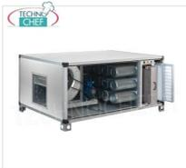
Steuereinheit für Absaugung, Filterung und Geruchsneutralisierung mit 36 Zylindern aus pflanzlicher Aktivkohle, elektrostatischen und synthetischen Vorfiltern, max. Durchflussrate 12000 m<sup>3</sup>/cu/h, U/min 1000, V.400/3, Kw.5, Gewicht 425 kg, Maße 2100 x 1280 x 1280 mm
