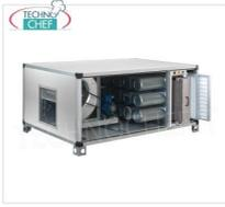
Saug-, Filter- und Desodorierungs-Steuereinheit mit 18 Zylindern aus pflanzlicher Aktivkohle, elektrostatischen und synthetischen Vorfiltern, max. Durchflussrate 6000 m<sup>3</sup>/cu/h, 1200 U/min, V.400/3, Kw.2,2, Gewicht 285 kg, Maße 1800 x 1280 x 800 mm
