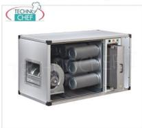
**DESODORISIERUNGS-STEUREINHEIT mit 9 ZYLINDERN pflanzlicher Aktivkohle und elektrostatischem Vorfilter, max. Durchflussrate 3000 m<sup>3</sup>/cu/h, 1400 U/min, V.230/1, Kw.1,35, Gewicht 100 kg, Maße 1300 x 670 x 750 mm**
