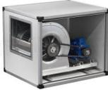
GEHÄUSEABSAUGER mit ZENTRIFUGALGÜTER mit ANTRIEBSRIEMEN und RIEMENSCHLEIBEN, EDELSTAHL-Platten, 2 GESCHWINDIGKEITEN, max. Durchflussrate 9000/5979 m<sup>3</sup>/Kubikmeter/Stunde, U/min 810/538, dB 69/59, V.380/3, Kw.2,2/0,75, Gewicht 113 kg, Abm. 1000 x 900 x 900 mm
