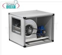
GEHÄUSEABSAUGER mit ZENTRIFUGALGÜTER mit ANTRIEBSRIEMEN und RIEMENSCHLEIBEN, EDELSTAHL-Platten, 2 GESCHWINDIGKEITEN, max. Durchfluss 12000/8028 m<sup>3</sup>/Kubikmeter/Stunde, U/min 780/522, dB 76/64, V.380/3, Kw.4,2/1,4, Gewicht 117 kg, Abm. mm.1200x1000x1000h
