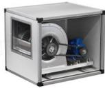
GEHÄUSEABSAUGER mit ZENTRIFUGALGÜTER mit ANTRIEBSRIEMEN und RIEMENSCHLEIBEN, EDELSTAHL-Platten, 2 GESCHWINDIGKEITEN, max. Durchfluss 7000/4715 m<sup>3</sup>/Kubikmeter/Stunde, U/min 1140/768, dB 74/62, V.380/3, Kw.3,0/0,9, Gewicht 113 kg, Abm. 1000 x 900 x 900 mm
