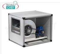
GEHÄUSEABSAUGER mit ZENTRIFUGALGÜTER mit ANTRIEBSRIEMEN und RIEMENSCHLEIBEN, EDELSTAHL-Platten, 2 GESCHWINDIGKEITEN, max. Durchfluss 12000/8028 m<sup>3</sup>/Kubikmeter/Stunde, U/min 870/582, dB 78/66, V.380/3, Kw.4,2/1,4, Gewicht 117 kg, Abm. 1200 x 1000 x 1000 mm
