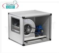
GEHÄUSEABSAUGER mit ZENTRIFUGALGÜTER mit ANTRIEBSRIEMEN und RIEMENSCHLEIBEN, EDELSTAHL-Platten, 2 GESCHWINDIGKEITEN, max. Durchfluss 13000/8757 m<sup>3</sup>/Kubikmeter/Stunde, U/min 730/492, dB 70/61, V.380/3, Kw.3,0/0,9, Gewicht 117 kg, Abm. 1200 x 1000 x 1000 mm
