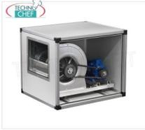
GEHÄUSEABSAUGER mit ZENTRIFUGALGÜTER mit ANTRIEBSRIEMEN und RIEMENSCHLEIBEN, EDELSTAHL-Platten, 2 GESCHWINDIGKEITEN, max. Durchfluss 10000/6736 m<sup>3</sup>/Kubikmeter/Stunde, U/min 800/539, dB 74/62, V.380/3, Kw.3,0/0,9, Gewicht 116 kg, Abm. 1200 x 1000 x 1000 mm
