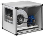
GEHÄUSEABSAUGER mit ZENTRIFUGALGÜTER mit ANTRIEBSRIEMEN und RIEMENSCHLEIBEN, EDELSTAHL-Platten, 2 GESCHWINDIGKEITEN, max. Durchflussrate 6000/3986 m<sup>3</sup>/Kubikmeter/Stunde, U/min 1150/764, dB 70/62, V.230/1, Kw.2,2/0,75, Gewicht 86 kg, Abm. mm.900x750x750h
