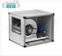
GEHÄUSEABSAUGER mit ZENTRIFUGALGÜTER mit ANTRIEBSRIEMEN und RIEMENSCHLEIBEN, EDELSTAHL-Platten, 2 GESCHWINDIGKEITEN, max. Durchfluss 11000/7410 m<sup>3</sup>/Kubikmeter/Stunde, U/min 770/519, dB 69/59, V.380/3, Kw.3,0/0,9, Gewicht 117 kg, Abm. 1200 x 1000 x 1000 mm
