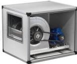
GEHÄUSEABSAUGER mit ZENTRIFUGALGÜTER mit ANTRIEBSRIEMEN und RIEMENSCHLEIBEN, EDELSTAHL-Platten, 2 GESCHWINDIGKEITEN, max. Durchflussrate 8000/5315 m<sup>3</sup>/Kubikmeter/Stunde, U/min 830/551, dB 68/55, V.380/3, Kw.2,2/0,75, Gewicht 113 kg, Abm. 1000 x 900 x 900 mm
