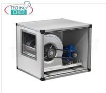
**GEHÄUSEABSAUGER mit ZENTRIFUGALGÜTER mit ANTRIEBSRIEMEN und RIEMENSCHLEIBEN, EDELSTAHL-Platten, 2 GESCHWINDIGKEITEN, max. Durchfluss 2500/1673 m<sup>3</sup>/Kubikmeter/Stunde, U/min 1450/970, dB 67/52, V.380/3, kW.0,81/0,28, Gewicht 41 kg, Maße mm.800x600x600h**
