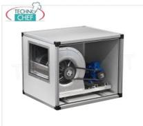
**GEHÄUSEABSAUGER mit ZENTRIFUGALGÜTER mit ANTRIEBSRIEMEN und RIEMENSCHLEIBEN, EDELSTAHL-Platten, 2 GESCHWINDIGKEITEN, max. Durchflussrate 2.000/1317 m<sup>3</sup>/Kubikmeter/Stunde, U/min 1440/948, dB 65/52, V.380/3, kW.0,55/0,18, Gewicht 40 kg, Maße mm.800x600x600h**
