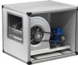
GEHÄUSEABSAUGER mit ZENTRIFUGALGÜTER mit ANTRIEBSRIEMEN und RIEMENSCHLEIBEN, EDELSTAHL-Platten, 2 GESCHWINDIGKEITEN, max. Durchflussrate 8000/5389 m<sup>3</sup>/Kubikmeter/Stunde, U/min 1100/741, dB 75/62, V.380/3, Kw.3,0/0,9, Gewicht 113 kg, Abm. 1000 x 900 x 900 mm
