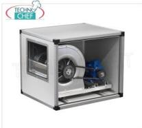
GEHÄUSEABSAUGER mit ZENTRIFUGALGÜTER mit ANTRIEBSRIEMEN und RIEMENSCHLEIBEN, EDELSTAHL-Platten, 2 GESCHWINDIGKEITEN, max. Durchflussrate 15000/10034 m<sup>3</sup>/Kubikmeter/Stunde, U/min 700/468, dB 73/64, V.380/3, Kw.4,2/1,4, Gewicht 118 kg, Abm. mm.1200x1000x1000h
