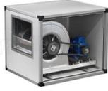
GEHÄUSEABSAUGER mit ZENTRIFUGALGÜTER mit ANTRIEBSRIEMEN und RIEMENSCHLEIBEN, EDELSTAHL-Platten, 2 GESCHWINDIGKEITEN, max. Durchfluss 7000/4650 m<sup>3</sup>/Kubikmeter/Stunde, U/min 1050/698, dB 69/59, V.380/3, Kw.2,2/0,75, Gewicht 87 kg, Abm. 900 x 750 x 750 mm
