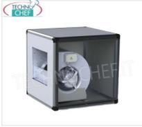
**GEHÄUSEABSAUGER mit ZENTRIFUGALGÜTER mit DIREKT mit dem LAUFRAD VERBUNDENEM MOTOR, EDELSTAHL-Platten, max. Durchflussrate 10.000 m<sup>3</sup>/cu/Stunde, 920 U/min, 1 Geschwindigkeit, db 55, V.400/3, Kw.2,2, Gewicht 102 kg, Maße mm.900x900x900h**
