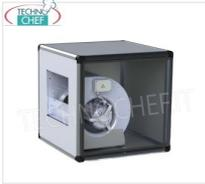
GEHÄUSESAUGGERÄT mit ZENTRIFUGALGÜTER mit DIREKT mit dem LAUFRAD VERBUNDENEM MOTOR, EDELSTAHL-Platten, max. Durchflussrate 1.500 m<sup>3</sup>/Kubikfuß/Stunde, 970 U/min, 1 Geschwindigkeit, db 45, V.230/1, Kw. 0,250, Gewicht 28 kg, Maße mm 500 x 500 x 500 h
