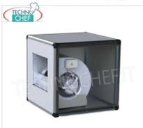
GEHÄUSEABSAUGER mit ZENTRIFUGALGÜTER mit DIREKT mit dem LAUFRAD VERBUNDENER MOTOR, EDELSTAHL-Platten, max. Durchflussrate 4.000 m<sup>3</sup>/cu/Stunde, 940 U/min, 1 Geschwindigkeit, db 52, V.230/1, Kw.0,57, Gewicht 67 kg, Maße mm.750x750x750h
