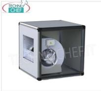
GEHÄUSESAUGGERÄT mit ZENTRIFUGALGÜTER mit DIREKT mit dem LAUFRAD VERBUNDENEM MOTOR, EDELSTAHL-Platten, max. Durchflussrate 3.000 m<sup>3</sup>/Kubikfuß/Stunde, 880 U/min, 1 Geschwindigkeit, db 48, V.230/1, Kw. 0,373, Gewicht 36 kg, Maße 600 x 600 x 600 mm
