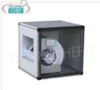
GEHÄUSESAUGGERÄT mit ZENTRIFUGALGÜTER mit DIREKT mit dem LAUFRAD VERBUNDENEM MOTOR, EDELSTAHL-Platten, max. Durchflussrate 2.000 m<sup>3</sup>/Kubikfuß/Stunde, 940 U/min, 1 Geschwindigkeit, db 48, V.230/1, Kw. 0,25, Gewicht 33 kg, Maße 600 x 600 x 600 mm
