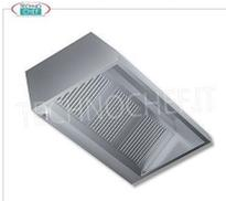
**Wand-Dunstabzugshaube aus Edelstahl 430 ohne Motor, mit 2 Labyrinth-Fettfiltern, Gewicht 55 kg, Maße 1200 x 1100 x 450 mm**
