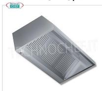
Wand-Dunstabzugshaube aus Edelstahl 430 ohne Motor, mit 2 Labyrinth-Fettfiltern, Gewicht 53 kg, Maße 1400 x 900 x 450 mm
