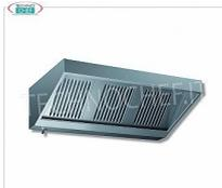
Wandmontierte Dunstabzugshaube aus Edelstahl 430 mit Motor, Serie SNACK, mit 6 Labyrinth-Fettfiltern, V.230/1, 0,42 kW, Gewicht 110 kg, Maße 2800 x 1100 x 450 mm
