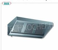
**Wandmontierte Dunstabzugshaube aus Edelstahl 430 mit Motor, Serie SNACK, mit 2 Labyrinth-Fettfiltern, V.230/1, 0,147 kW, Gewicht 64 kg, Maße 1400 x 1100 x 450 mm**
