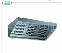
**Wandmontierte Dunstabzugshaube aus Edelstahl 430 mit Motor, Serie SNACK, mit 2 Labyrinth-Fettfiltern, V.230/1, 0,147 kW, Gewicht 59 kg, Maße 1200 x 1100 x 450 mm**
