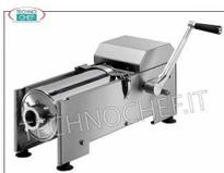
**Tisch-Wurst-/Salamifüller aus Edelstahl, 2 manuelle Geschwindigkeiten mit horizontalem Zylinder, Fassungsvermögen 14 Liter, geliefert mit 3 ABS-Trichtern Durchmesser 8 - 16,5 und 23,5 mm, Abm. mm 1550x450x450h**
