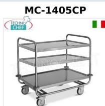
**Schwerlast-Transportwagen aus Edelstahl mit 3 verschweißten Pressblechböden 800 x 500 mm, max. Tragkraft 200 kg, Maße 890 x 590 x 950 h mm**
